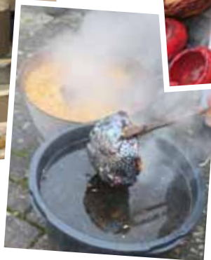
Emnerne brændes og lægges lynhurtigt i savsmuld (iltfattigt miljø). Efter en kort afkøling skal emnerne afkøles yder- ligere i vand. Alle processer har indvirkning på det færdige resultat.
